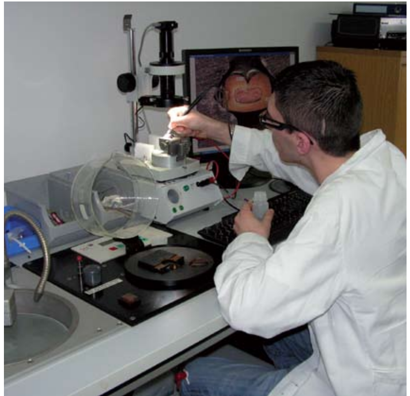
Bild: Arbeitsplatz zur Analyse von Crimpverbindungen
